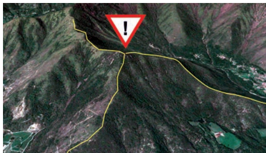
NŒUD DE CRÊTES (IDENTIFIÉ PAR LE SYMBOLE DE DANGER) (Pao Costa 2011) EN HAUT, INTERSECTION INFÉRIEURE DES CRÊTES ET DU FOND DU TALWEG (EN JAUNE, LE CONTOUR DE LA SURFACE POTENTIELLE DE L'INCENDIE) EN BAS, INTERSECTION HAUTE DES CRÊTES (EN JAUNE, LA ZONE DE PASSAGE POTENTIEL VERS LA VALLÉE VOISINE PENDANT LA NUIT)
