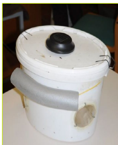
Fig. 3 : Nasse de type « Ortmann », vue de détail
